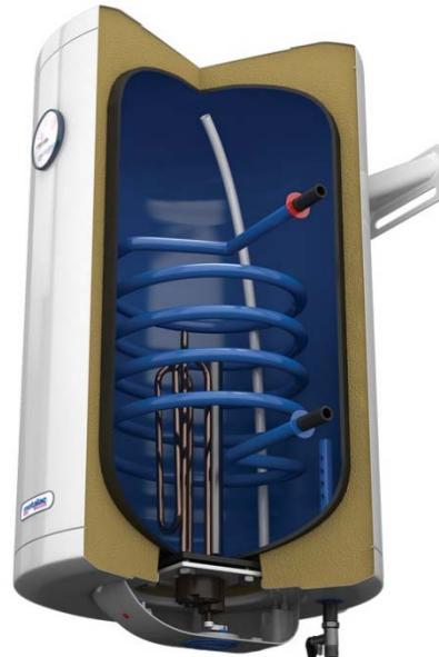
Dodatna pogodnost za građane bi bila i mogućnost korištenja kombinovanih bojlera za zagrijavanje vode, koji su sada zabranjeni. Radi se o bojlerima koji imaju dva seta cijevi, jedan za toplu vodu iz instalacija grijanja, a drugi za čistu vodu iz vodovoda. Umjesto da se troši električna energija za grijanje vode, koristi se toplota iz centralnog grijanja. Kod tarifiranja po površini, ovakav način grijanja vode je čisti gubitak, dok se kod tarifiranja po potrošnji ta energija može naplatiti.
